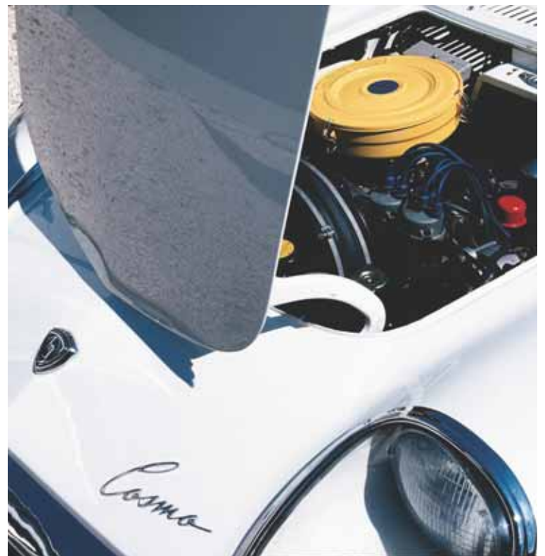
Der legendäre Kreiskolben-Motor des Cosmo Sport 110 S.
