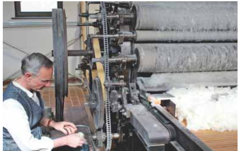
Die über 100 Jahre alte Krempelmaschine hat der studierte Maschinenbauer Stefan Reinsch selbst zusammengebaut.
